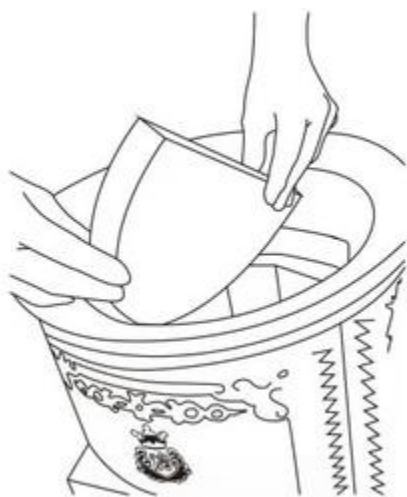
3. Ta bort deflektorn i stål och delarna på sidan (F), den främre rökhyllan (E) och slutligen den bakre rökhyllan(D).
